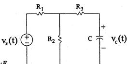
Here,  $R_1=2k\Omega,\ R_2=2k\Omega,\ R_3=3k\Omega,\ C=2.5\mu F.$
