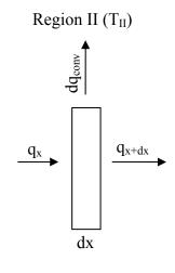
$$q_x - q_{x+dx} - dq_{conv} + dq_{gen} = 0 \qquad q_x - q_{x+dx} - dq_{conv} = 0$$
